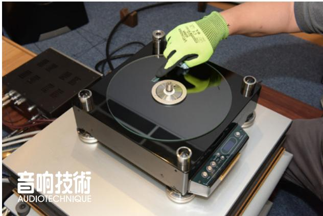
△ AF III Premium的唱盘基座摆放在一块基本上水平的稳固平台上，安装转盘的位置是一块经过精细打磨，表面完全平滑的玻璃片，当炮铜合金转盘放上去之后，空气回承装置便会把转盘浮起30微米( $\mu\text{m}$ )形成一层空气膜做成气浮效果。
