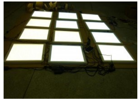
Planta de producción — Control de calidad y testeo de degradación de la luz a 3,000 horas de servicio.
