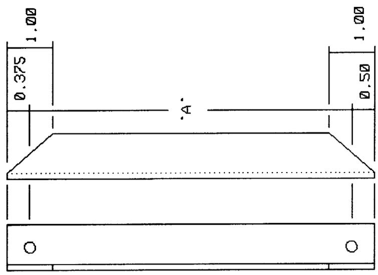
MATERIAL: 1 X 1 X 1/8 6061-T6 ALUM, EXTRUSION
