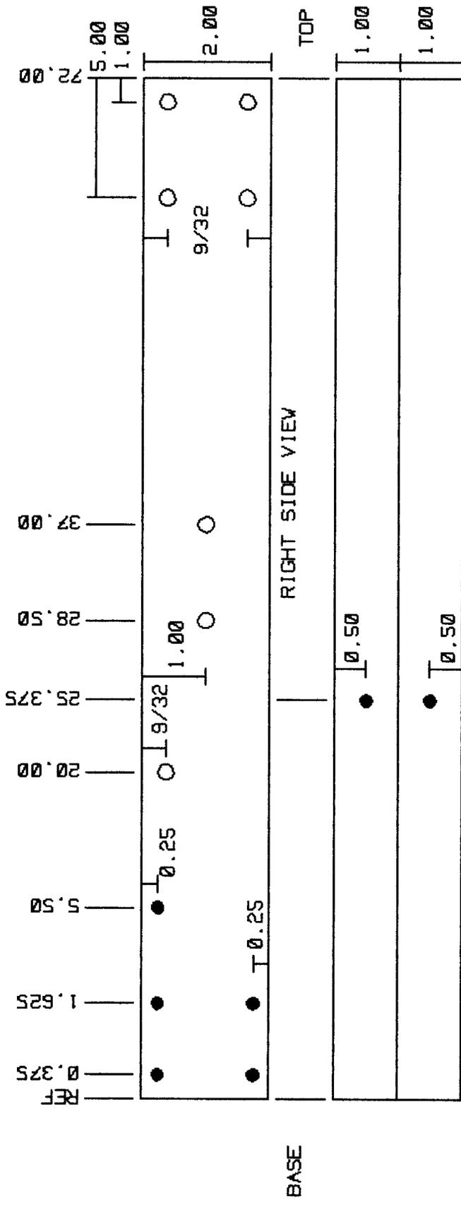
MATERIAL: 2 PIECES OF 2 x 1 x 1/8 WALL 6061-T6 EXTRUDED TUBE STOCK
