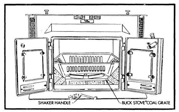
COAL GRATE AND REFRACTORY SIDE LINING
