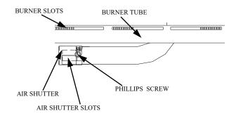
FIGURE 21 - BURNER/ AIR SHUTTER
