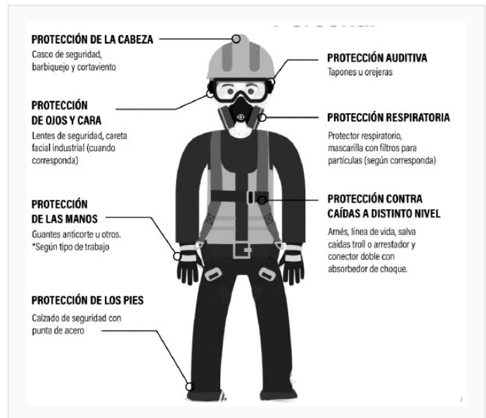
Equipo de protección personal obligatorio durante la descarga.
