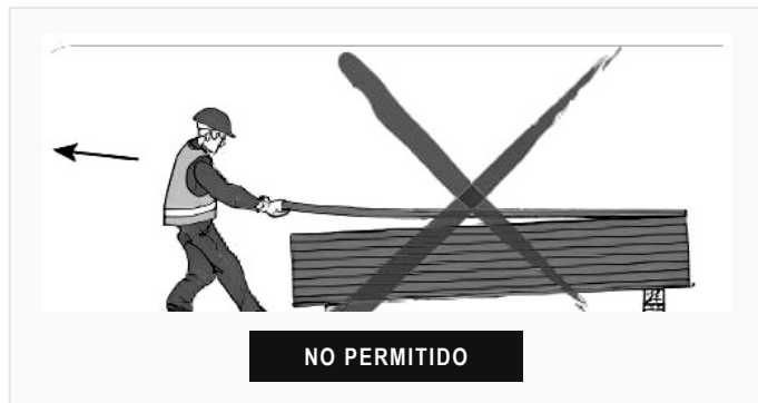
Arrastre del material sobre el suelo.
