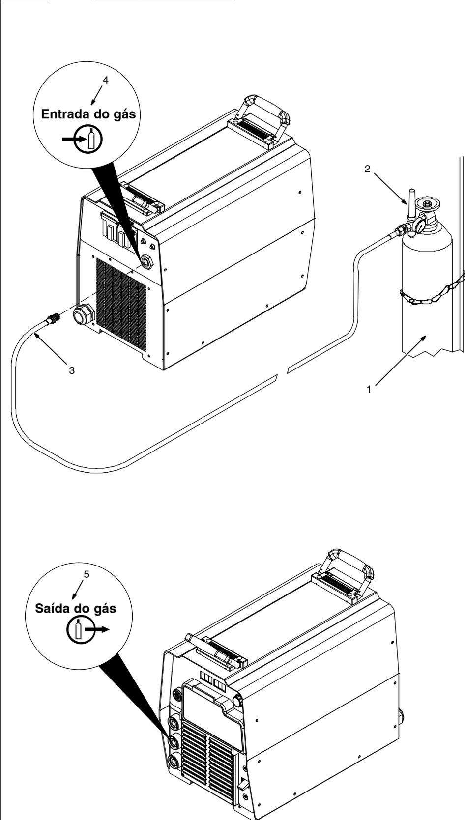
Fixe o cilindro do gás com uma corrente ao carrinho de transporte, a uma parede ou a qualquer outro suporte estacionário de forma que ele não possa tombar e quebrar a válvula.
