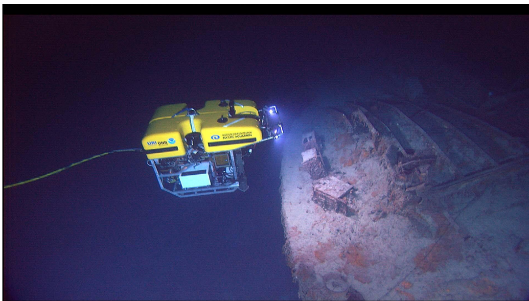
Fig. 4-7 ROV realizando busca de casco sofocado
