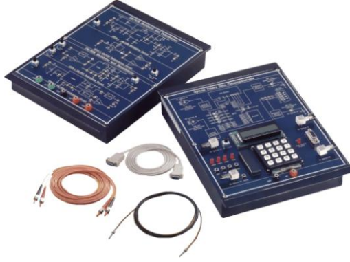
Uygulama 2.1.1: Fiber optik deney seti
