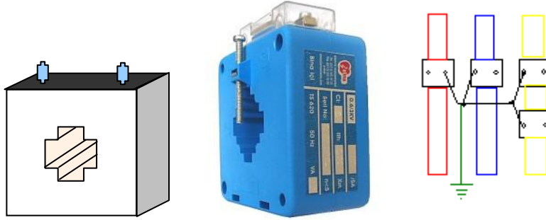
Resim 3.4: Akım trafosu ve topraklama bağlantısı
