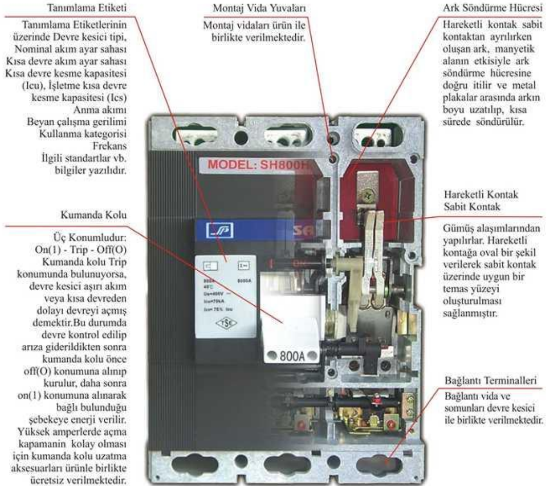
Resim 1.6: Kompakt şalter iç yapısı
