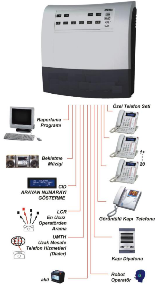
Resim 1.2: Bina içi haberleşme tesisatında kullanılan cihazlar
