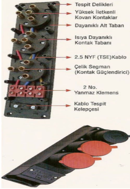
Resim 2.10: Kauçuk uzatma prizi montajı ve priz bağlantıları
