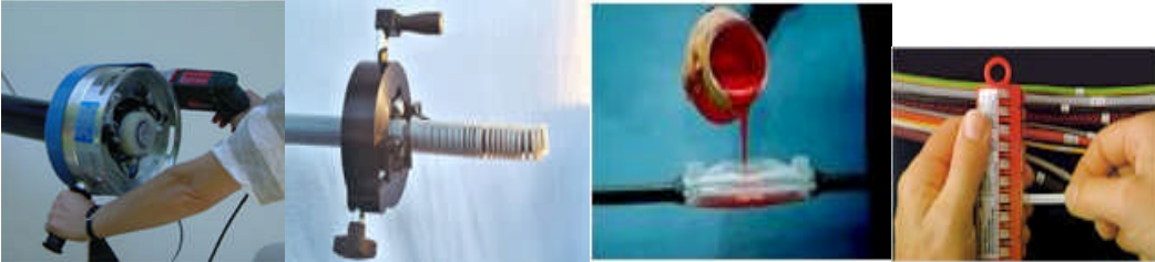
Resim 5.4: Kablo soyma aparatı, ek yerinin yalıtılması ve kablo kodlama
