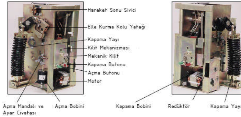
Şekil 1.3: Kesici işletme mekanizması
