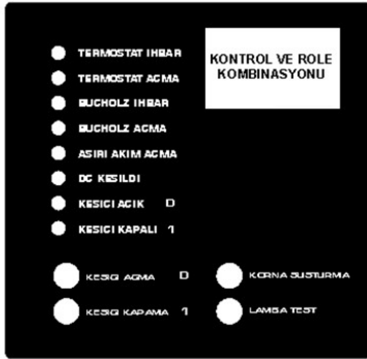
Resim 1.9: İhbar röle kombinasyonu ön panel görünüşü
