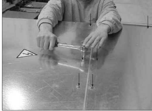
Resim 2.4: Üst kapak sacının yerine takılması
