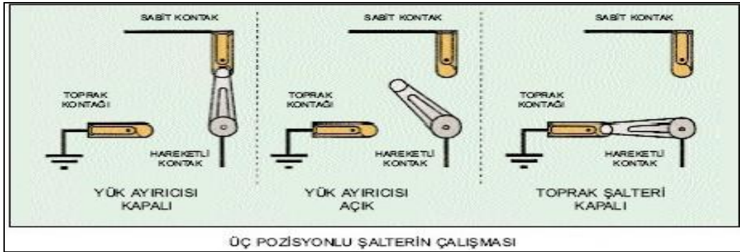
Şekil 1.11: SF6 yük ayırıcı kontak pozisyonları
