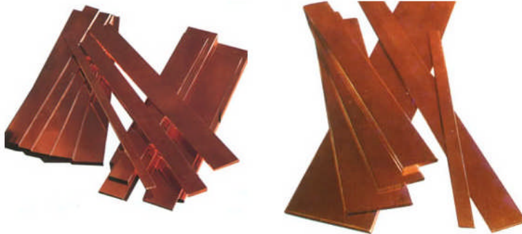
Resim 1.1: Çeşitli boyutlardaki bakır lamalar
