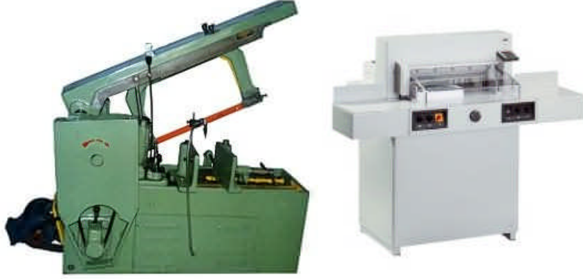
Resim 1.5: Büyük boyutlardaki lamaların kesilmesinde kullanılan hidrolik testere ve giyotin
