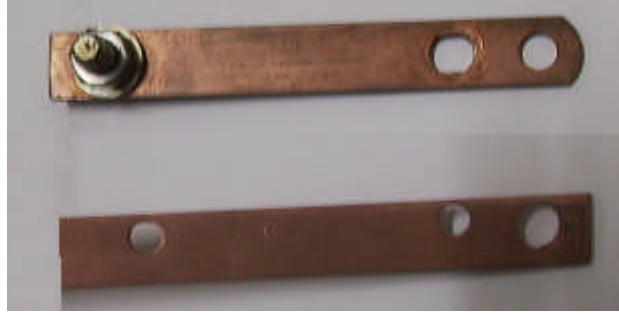
Resim 3.1: Altta ucu köşeli, üstte ucu yuvarlatılmış bara
