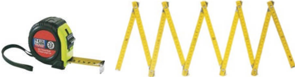
Resim 1.4: Ölçü almada kullanılan şerit ve katlanabilir metreler
