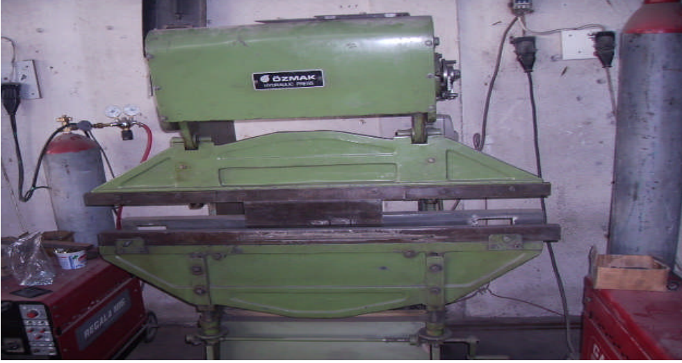
Resim 2.6: Atölyede bükme pres (Elektrik motorlu)
