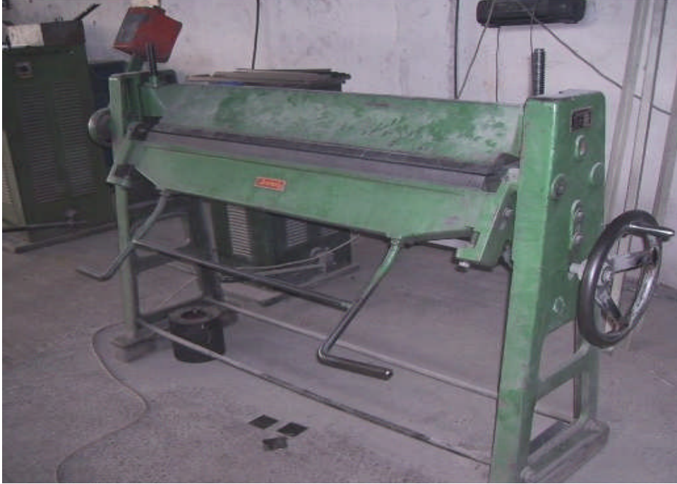
Resim 2.7: Atölyede diğer bir bükme pres (insan gücü ile çalışan pres)
