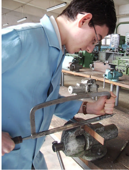
Resim 1.8: Demir testeresi ile kesme işlemi yaparken lamayı mengenede sabitlenerek kesme işlemi yapılması
