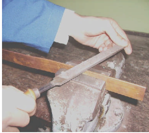
Resim 3.6: Baranın mengeneye bağlanması ve eĐe yardımı ile oksit tabakalarının yok edilmesi
