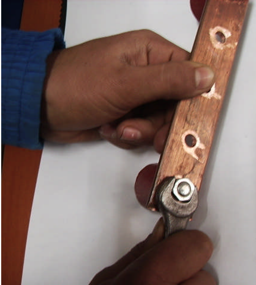
Resim 4.4: Açık ağızlı anahtar kullanılarak somunların sıkılması
