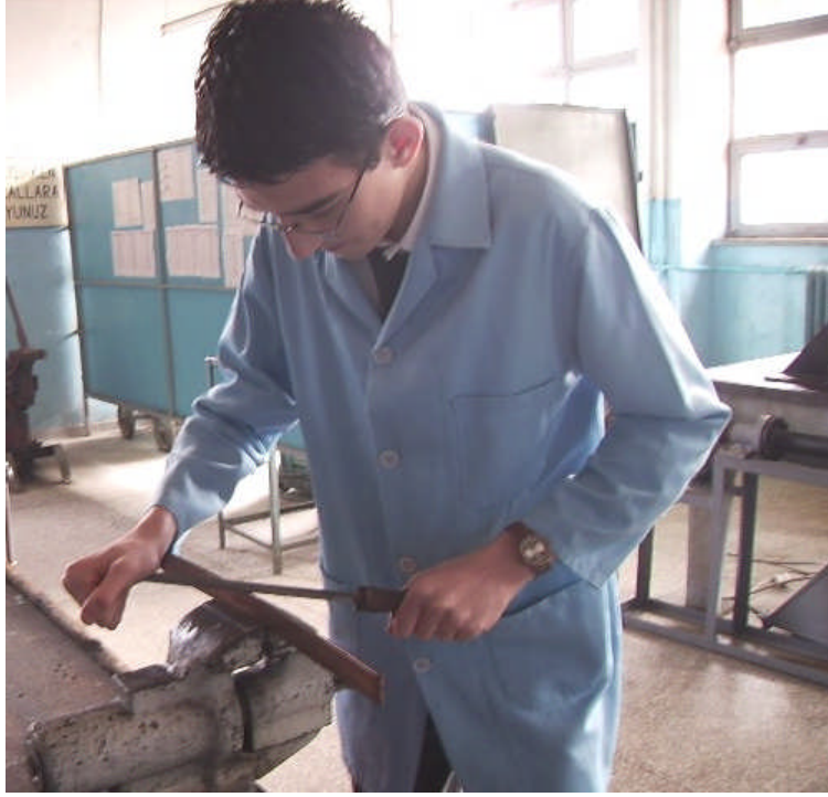
Resim 3.5: Atölye ortamında bara temizliĐinin yapılması
