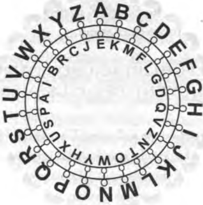
Şekil 3 Enigma rotor elektrik bağlantıları
