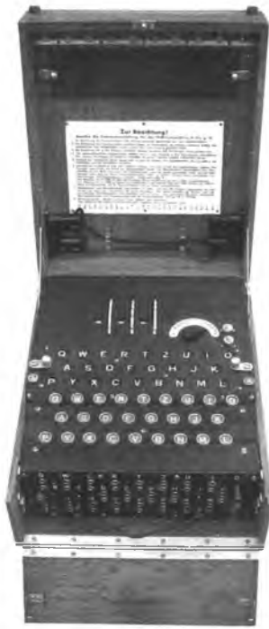
Şekil 1 3 Rotorlu Enigma Makinesi (Resim, www.ilord.com sitesinin sahibi olan Bob Lord'un izniyle kitapta kullanılmıştır)
