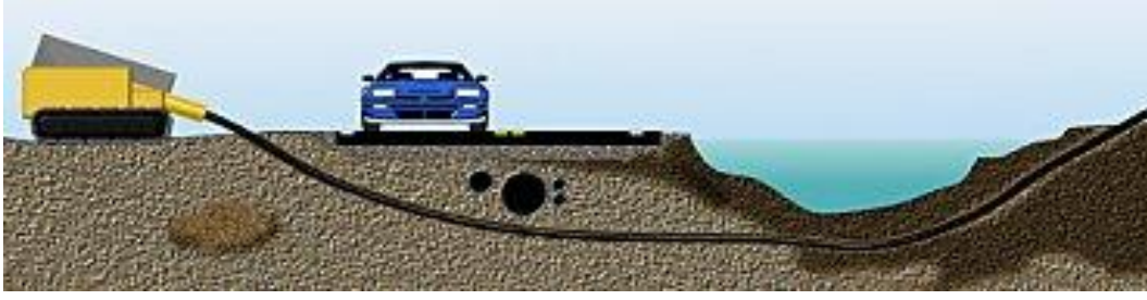
Şekil 2.17: Kablonun sualtı zemin içinden çekilmesi
