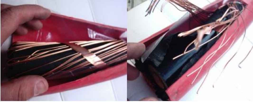
Resim 3.10: YE3SV kablunun bakır şeridi ve telleri, kağıt koruyucu(siyah) ve yarı iletken tabaka
