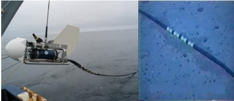
Resim 2.24: Denizden kablo çekme aracı ve kablonun deniz içindeki görünümü
