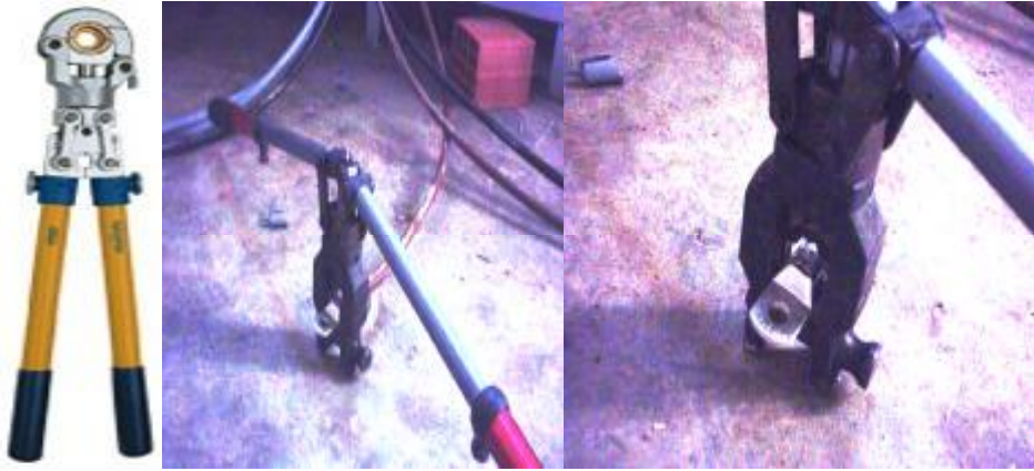
Resim 4.4: Pabucun pens ile sıkılması yöntemi
