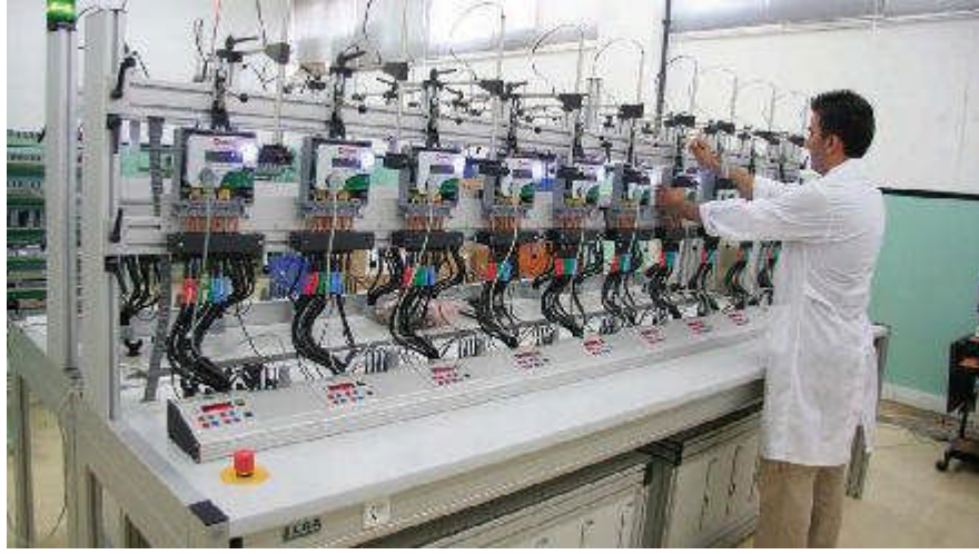
Resim 2.17: Elektrik sayaç kontrol laboratuvarı
