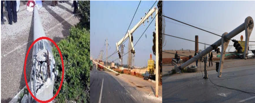
Resim 1.26: Beton direğin kırılması
