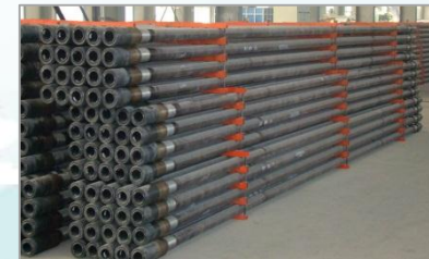
Tuberías de Perforación
