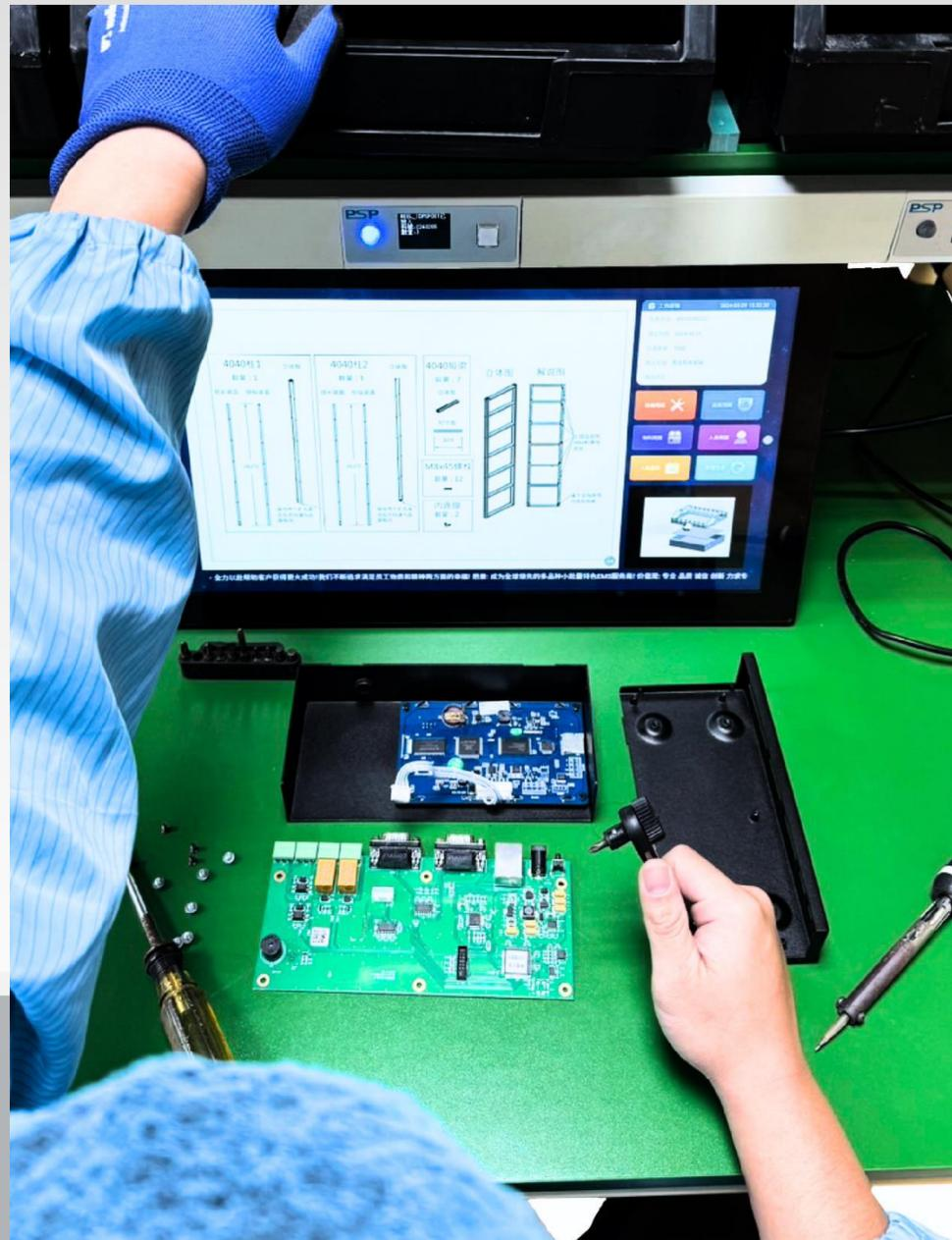
我們的智能CELL工作站，搭載了先進的高速攝影機，能夠精準辨識操作人員的操作流程是否正確。高速攝影機可以進行高速拍攝，同時支持低速回放，讓每個細節都清晰可見。產品還配備了大尺寸平板顯示器，能夠實時展示操作流程。結合電子標籤技術，每一個操作動作都對應一個畫面顯示，確保操作步驟準確無誤。
