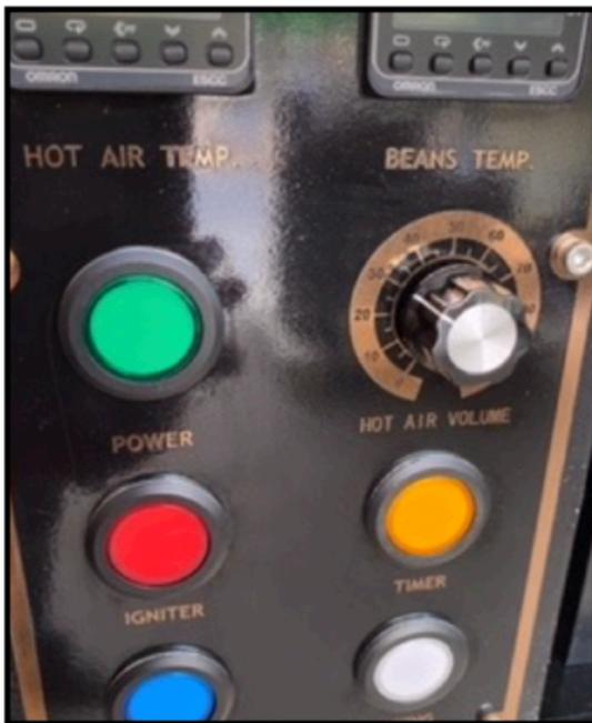
**NEW PRECISE ELECTRONIC AIRFLOW CONTROL**
