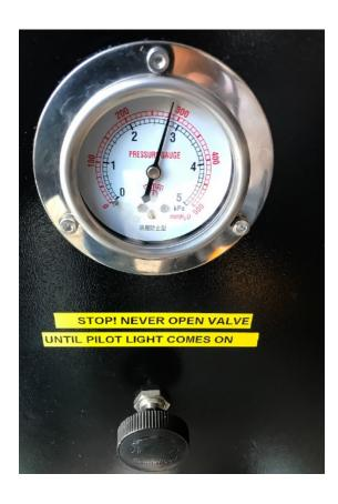
THEN ONLY <u>AFTER</u> PILOT BURNER IGNITES CAN YOU SLOWLY TURN ON GAS VALVE ON FRONT OF ROASTER:
