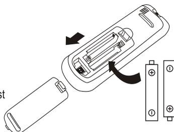
⚠ Pour certains modèles de télécommandes, ouvrez le couvercle du compartiment à piles, et vous pouvez voir l'interrupteur manuel au fond, puis vous pouvez sélectionner Cooling only (Refroidissement seul) ou Heating pump (Pompe à chaleur), fonctionnement comme ci-dessous.
